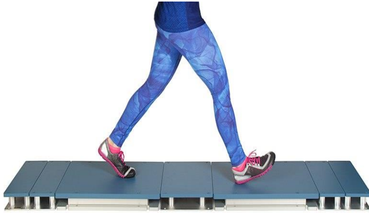
Resim 1. Yer tepki kuvveti (YTK) ölçümünde zemine gömülü şekilde kullanılan kuvvet platformu 12
